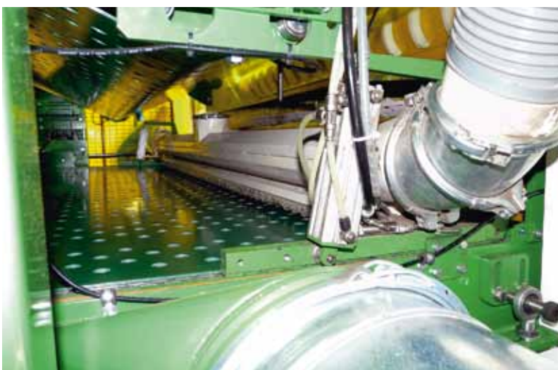
Das Vakuum-Auszugsband ermöglicht eine exakte Schuppung ohne Verdrehung der Bogen.
